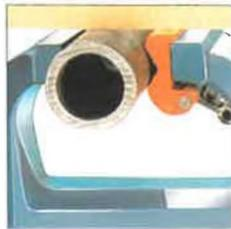
Ganasce per tubi a fissaggio rapido, che trasformano la Matador in una perfetta morsa per tubi.
