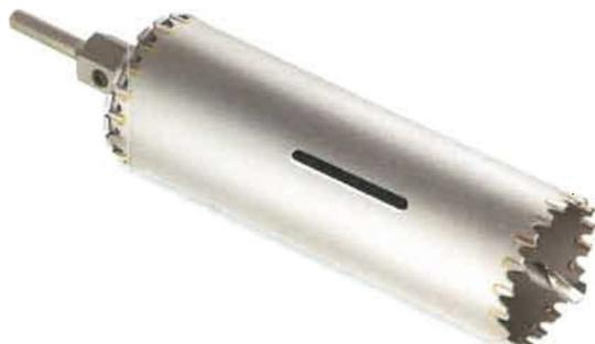
Queste corone doppie, provviste di speciali aperture per l'estrazione della polvere, sono particolarmente indicate per forare materiali teneri, quali legno ed intonaco, ma possono anche forare cemento e mattoni. Sono disponibili corone complete (corona, codolo e punta di centraggio) o solo corone. Il corpo della corona è provvisto di dentatura su entrambe le estremità; quando usurata può essere utilizzata l'altra estremità.
