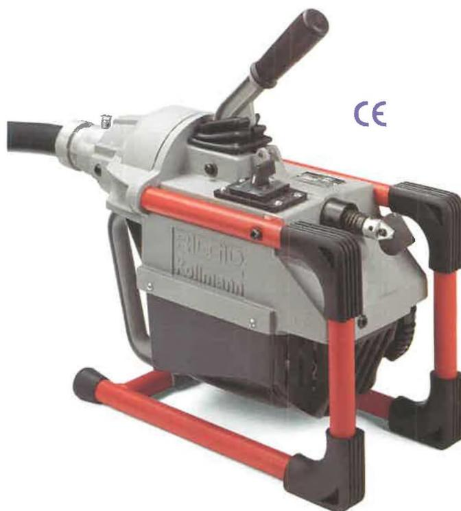
La semplice rotazione di una vite consente l'impiego di cavi da 16mm o da 22mm senza la necessity di alcun adattatore. Con gli adattatori A-17A e A-17B si utilizzano cavi da 8mm o da 10mm.
