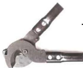
I tranciabulloni Ridgid sono progettati per dare prestazioni meccaniche elevate nel taglio rapido e facile di tondi, reti metalliche, armature per cemento, cavi, bulloni, ecc. Rapida regolazione del meccanismo di leveraggio. Taglienti in acciaio temperato. Gli utensili sono trattati termicamente per poter dare robustezza e resistenza all'usura. Le lame piatte consentono un taglio rasato
