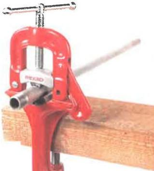
Apertura di bloccaggio fino a 4" (100mm)
