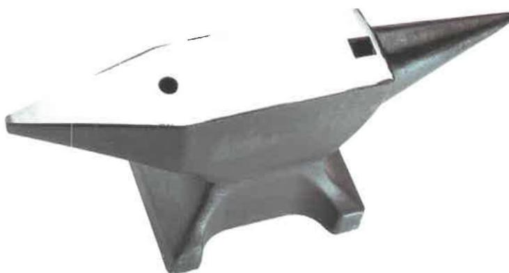
Interamente in acciaio forgiato per garantire la massima durata. Con piano di lavoro molato e temprato. Sei modelli con possibilità di scelta di uno o due corni (eccetto per il Modello N.12). E' disponibile un basamento portatile. Se riempito con sabbia conferisce stability e riduce la rumorosità. Si adatta a tutti i modelli di incudine (Catalogo N.14200).
